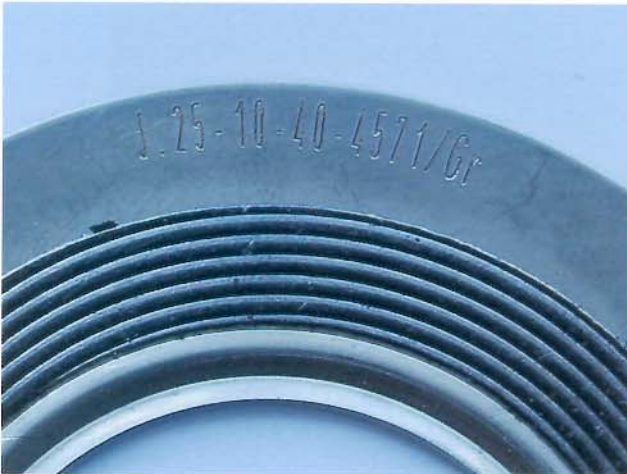
Eine Flachprofilichtung ECO+ nach dem Ausbau. Der Grafit hat sich den Flanschautiefen angepasst (schwarze Ringe).
