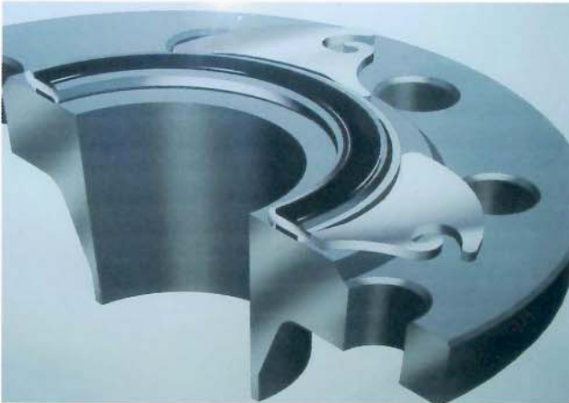
Schnitt durch eine gekapselte Profildichtung (Dichtmaterial in schwarz) mit Vario-Zentriersystem. Die Zentriersegmente (außen) sorgen für eine 100prozentige Zentrierung in allen Positionen.
