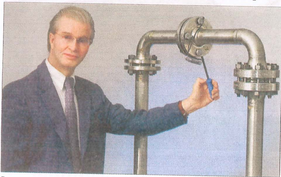
Das von dem in Struthütten geborenen Alfred Heinrich Jung entwickelte Dichtungssystem für Flanschverbindungen verhindert das Entweichen giftiger Gase. Foto: DBU
